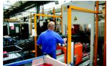
Der Bediener bestückt die Palette der automatisierten ST-30, während der Stück-Fertigung der zweiten Maschine (im Bild links hinten).
